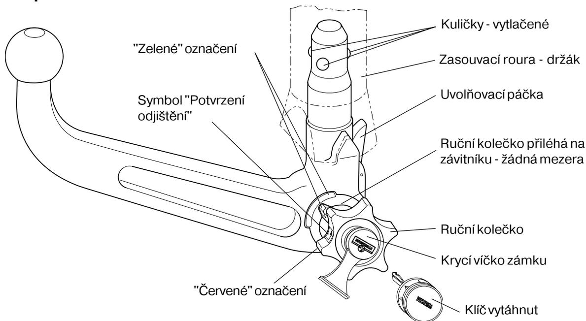
**Odjištěná pozice Vyndání kulové tyče**
