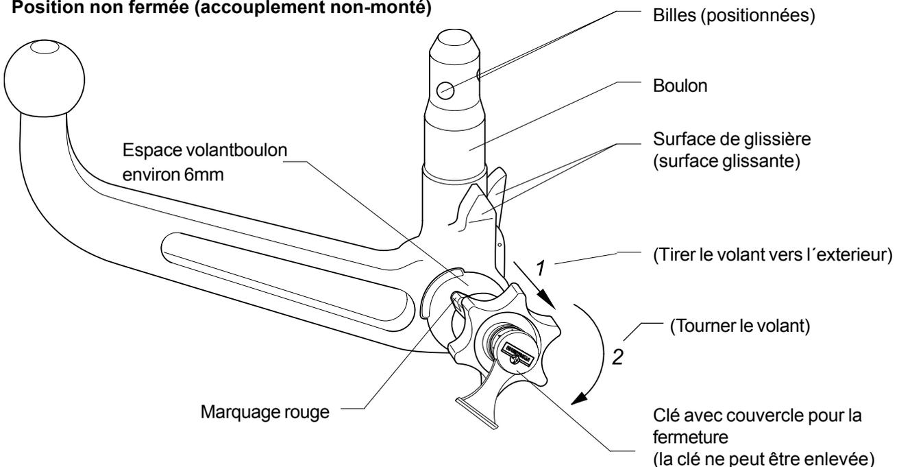
Direktiivin 94/20/EG mukainen hyväksymisnumero: **e13 00-1101**Luokka: **A50-X** Tyypin: **313 195**Tekniset tiedot: Suurin D-arvo: **11 kN**Suurin koukkukuorma: **120 kg****Käyttökohteet:** Ajoneuvonvalmistaja: **Mercedes Benz**Malli: **E-Klasse**yppimerkintä: **211**
